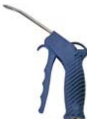
**Soufflettes avec buse Star-Tip** avec buse longue fixe en laiton de 100 mm et buse STAR-TIP selon les consignes suvaPro. Débit aisément réglable, poids 90 g.
