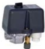
**Pressostat MDR 2** avec soupape de décharge EV-2 et bouton de commande marche/arrêt, courant alternatif bipolaire (contact à ouverture), IP 44, puissance de coupure (AC3): 2,2 kW/240 V.
