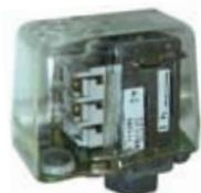
**Interrupteurs de commande MDR 43** commutateur de commande 1 contact à ouverture + 1 contact à fermeture, IP 44, mesure de la tension nominale et courant de service (AC15): 250 V / 8A. Le capot transparent permet la lecture de l'indication de la pression de déclenchement et la différence de pression. Même de petites différences de pression se laissent régler. Filetage de raccordement intérieur G 1/2.
