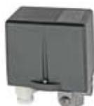
**Pressostats MDR 3** sans soupape de décharge, sans bouton de commande marche/arrêt, courant continu tripolaire (contact à ouverture), IP 54, puissance de coupure (AC3): 7,5 kW/500 V, filetage de raccordement intérieur G ½, raccordement au manomètre et 2 autres sorties filetage intérieur G ¼.
