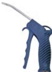
**Soufflettes** avec buse longue fixe en aluminium de 100 mm, buse avec alésage central et fente annulaire latérale, selon les consignes suvaPro. Débit aisément réglable, poids 75 g.
