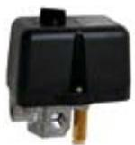
**Pressostat MDR 2** avec soupape de décharge EV-2/S et bouton de commande marche/arrêt, courant alternatif bipolaire (contact à ouverture), IP 44, puissance de coupure (AC3): 2,2 kW/240 V.
