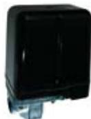
**Pressostats MDR 5** sans soupape de décharge, sans relais de surcharge, sans boutons poussoir marche/arrêt. Courant continu tripolaire (contact à ouverture), IP 54, puissance de coupure (AC3): 5,5 kW/400 V. Filetage de raccordement intérieur G 1/2. Raccordement au manomètre filetage intérieur G 1/4.
