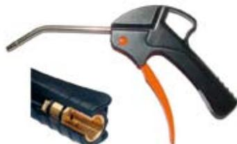
**Soufflettes de sécurité** en plastique POM résistant aux coups, avec buse longue fixe 130 mm, coudée, pression dosable, réduction de pression incorporée à 3,5 bar selon les consignes suvaPro, avec une très bonne capacité de soufflage, poids 120 g.
