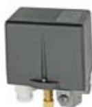
**Pressostats MDR 3** avec soupape de décharge EV-3S, sans bouton de commande marche/arrêt, courant continu tripolaire (contact à ouverture), IP 54, puissance de coupure (AC3): 7,5 kW/500 V, filetage de raccordement intérieur G ½, raccordement au manomètre et 2 autres sorties filetage intérieur G ¼.
