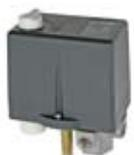
**Pressostats MDR 3** avec soupape de décharge EV-3S, relais de surcharge et bouton de commande marche/arrêt, courant alternatif bipolaire (contact à ouverture), IP 44, puissance de coupure (AC3): 2,5 kW/240 V, filetage de raccordement intérieur G ½ IG, raccordement au manomètre et 2 autres sorties filetage int. G ¼.
